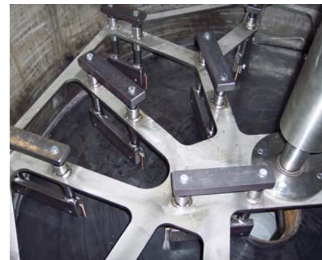
Schabewerk: Gewichte pressen die Rakel aus Kupfer auf den Heizboden.
